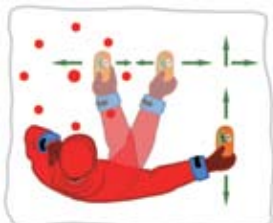
Nákvæm staðsetning er fundin með því að halda tækinu flötu yfir jörð. Tækið er haft á lægsta styrk og hlustað eftir hvar merkið er sterkast eða miðað við miðpunkt þess hvar merkið deyr út.
